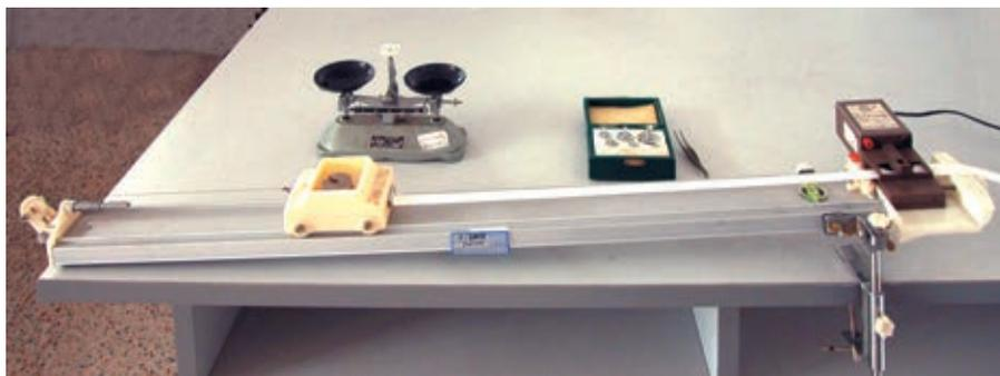
图 1-36 测量匀变速直线运动加速度的实验装置
