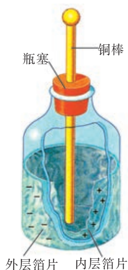
图 1-9 莱顿瓶的结构
