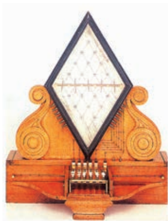
图2-29 1837年由库克和惠斯通发明的五针式电报机
