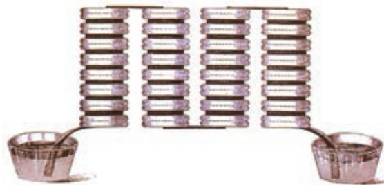
图 2-4 伏打的电堆是一连串用弄湿的布垫片隔开的金属圆板
