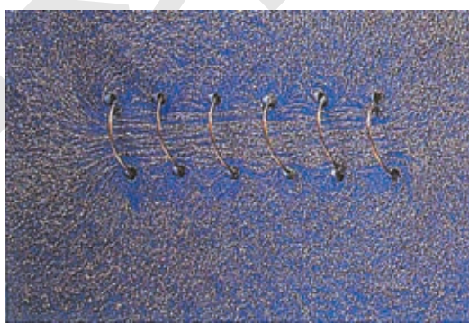
图 2-9 通电螺线管周围的铁屑
