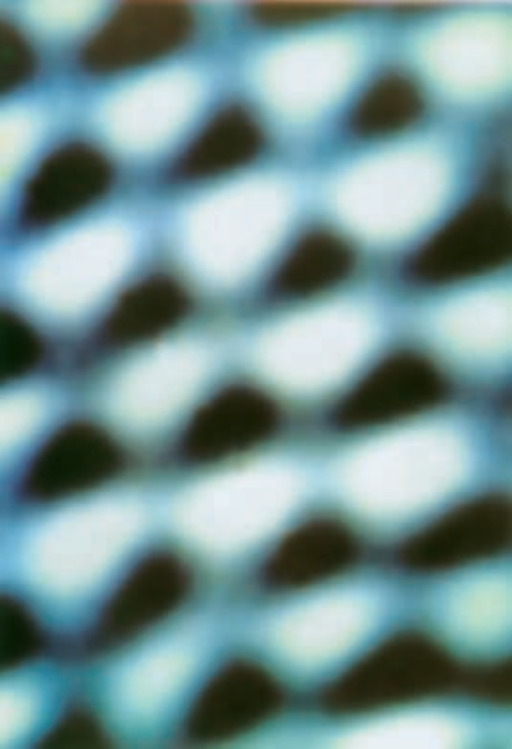
图 1-13 扫描隧道显微镜拍摄的石墨表面原子排列情况
