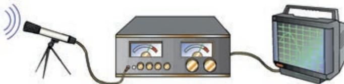
图 2-5 用示波器观察声波波形
