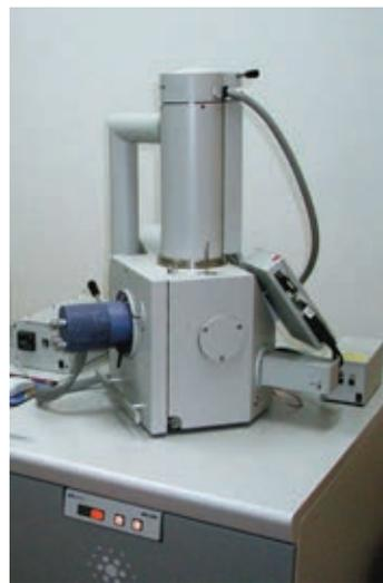
图 2-28 电子显微镜
