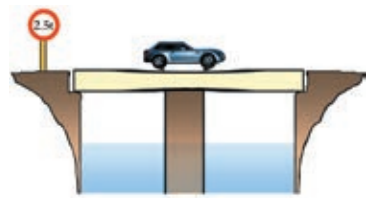
图 1-18 有桥墩的梁桥
