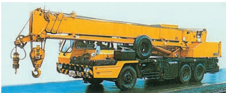
图 2-3 汽车式起重机
