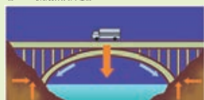
图 1-22 拱桥受力分析示意图
