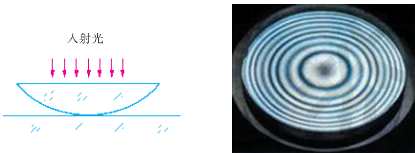
图 2-29 用牛顿环检验透镜质量示意图
