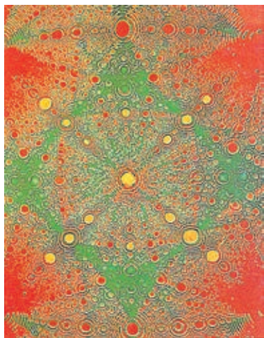
图 1-4 场离子显微镜(FIM)拍摄的图像显示了铂针顶端的原子(橘黄色)排列顺序,这个图像放大了 20 万倍
