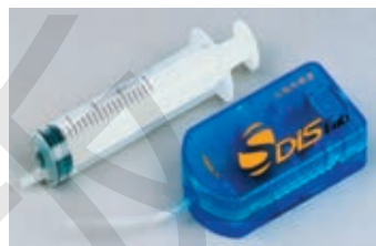
图 2-12 研究气体压强与体积关系的 DIS 实验主要仪器
