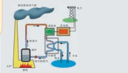
图 4-13 燃煤蒸汽发电厂运行流程图
