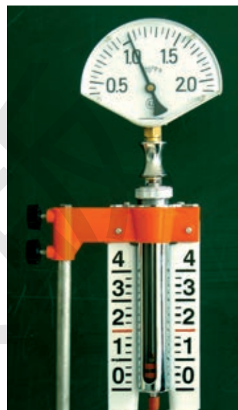
图 2-15 探究等容过程的实验装置
