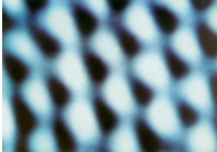
图 1-22 用扫描隧穿显微镜拍摄的石墨表面的原子排列情况
