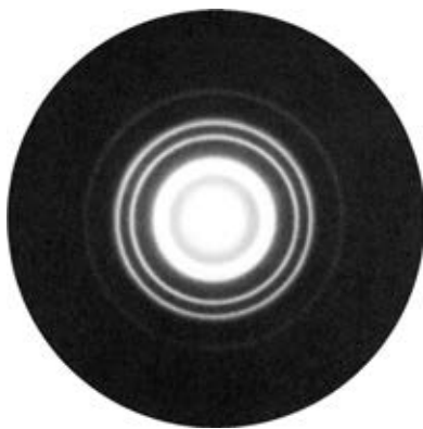
图 2-25 电子通过金箔的衍射图样
