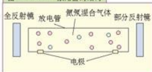
图 4.3-3 He-Ne 激光器的结构
