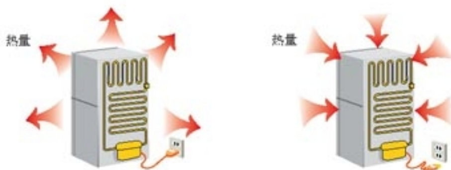
图 10.4-1 热量可以自发地从高温物体向低温物体传递，但要从低温物体向高温物体传递，必须有第三者的介入。
