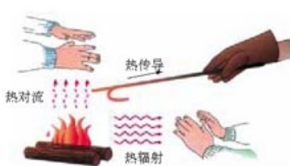
图 10.2-1 热传递的三种方式
