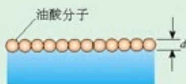
图7.1-1 水面上单分子油膜的示意图
