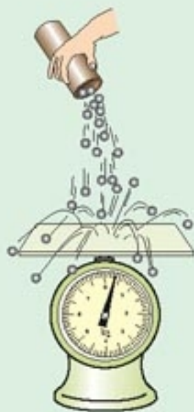
图8.4-4 模拟气体压强产生机理的实验
