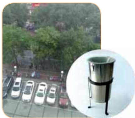
利用雨量器测量降雨量
