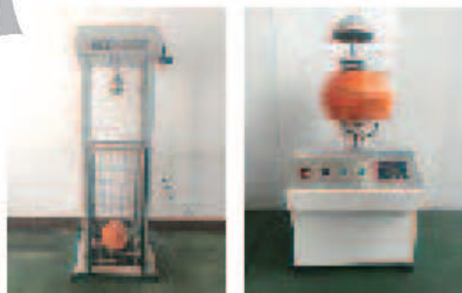
图2-28 安全帽的强化试验
